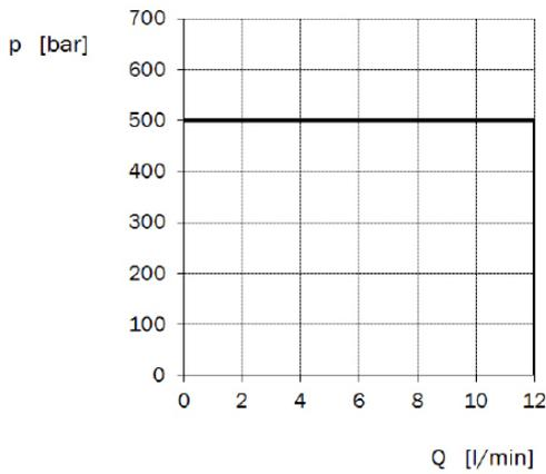
Hydraulische Schaltleistung bei Nennbetriebsspannung und Umgebungstemperatur  $T_a = 50^\circ \text{C}$
