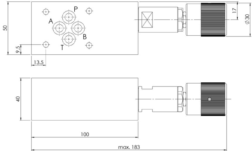
Zwischenplattenventil von A nach T
