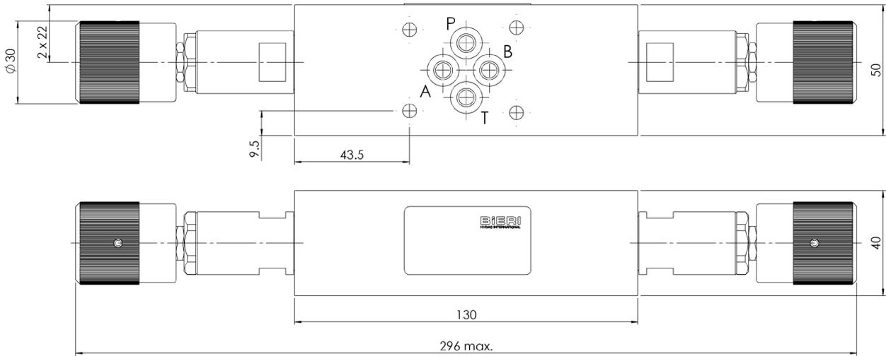
Zwischenplattenventil von P nach T und A nach T
