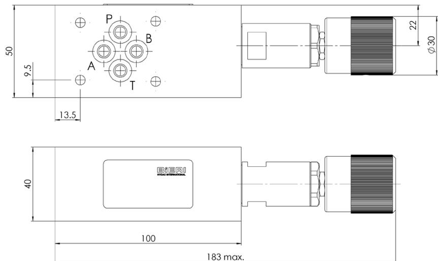
Zwischenplattenventil von A nach T und B nach T
