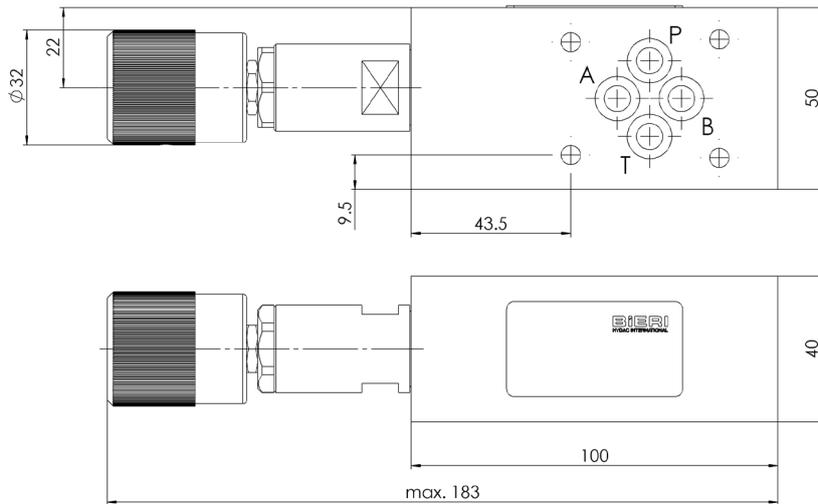
Zwischenplattenventil von B nach T
