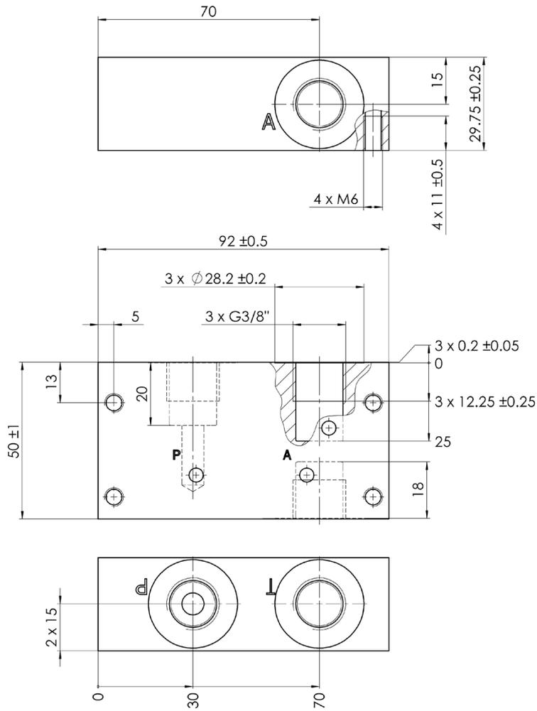
**Anschlusslochbild 2/2-, 3/2- und 4/2-Einzelanschlussplatten**
