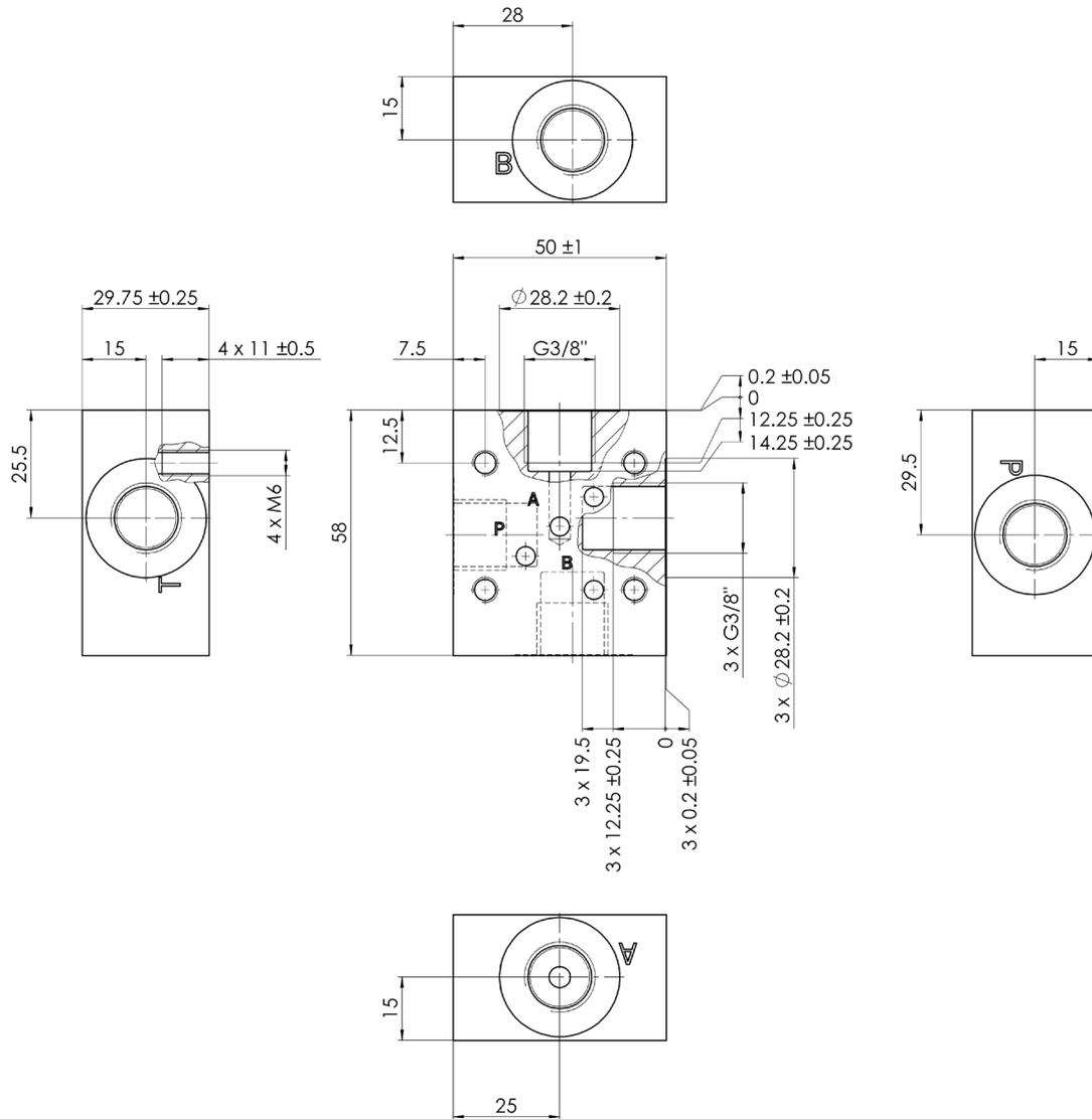
Bei Verwendung der Anschlussplatte muss der Stopfen im Anschluss B des Ventils entfernt werden und der Rohranschluss B am Ventil verschlossen werden.
